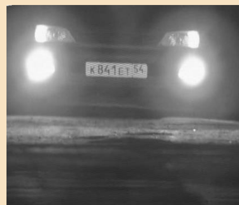
Активно-импульсный режим с дистанцией наблюдения на уровне переднего бампера автомобиля. Хорошо виден номер автомобиля
