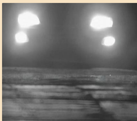
Активно-импульсный режим с дистанцией наблюдения за пределом автомобиля. Засветка от фар существенно уменьшена
