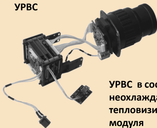
◀ УРВС в двухспектральном приборе наблюдения и пример комплексированного изображения
